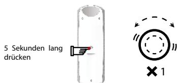
1. Drücken Sie die Einlern-Taste auf der Rückseite des Hand-/Wandsenders für 5 Sekunden. Der Motor wird einmal vibrieren.
