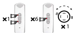
1. Drücken Sie die AUF- und AB-Taste einmal gleichzeitig und anschließend 6 x die STOP-Taste.
