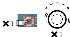
2. Drücken Sie anschließend innerhalb von 10 Sekunden kurz (maximal 1 Sekunde) die Lern-Taste am Motion Sensor.
