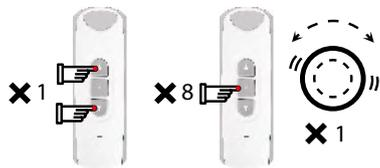
1. Drücken Sie 1x gleichzeitig die AUF- und AB-Taste eines bereits eingelernten Handsenders für maximal 1 Sekunde. Drücken Sie anschließend 8 x die STOPP-Taste. Der Motor wird einmal vibrieren.
