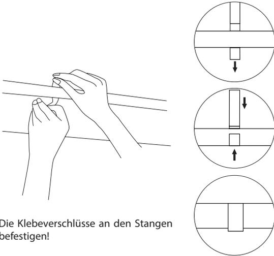
Die Klebeverschlüsse an den Stangen befestigen!
