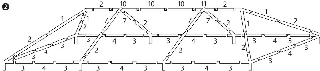
Achten Sie darauf, zuerst die Stangen 10 und 11 durch die Verbindungen schieben. Anschließend die anderen Stangen zusammenstecken.
