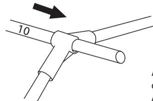
Achten Sie darauf, zuerst die Stange 10 durch die Verbindung durchschieben! Anschließend die Stangen mit der Nummer 2 an die Stange 10 stecken.
