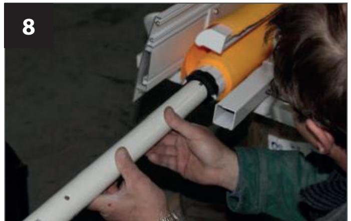
8 Schieben Sie den Motor mit der Mitnehmerseite in die offene Welle.
