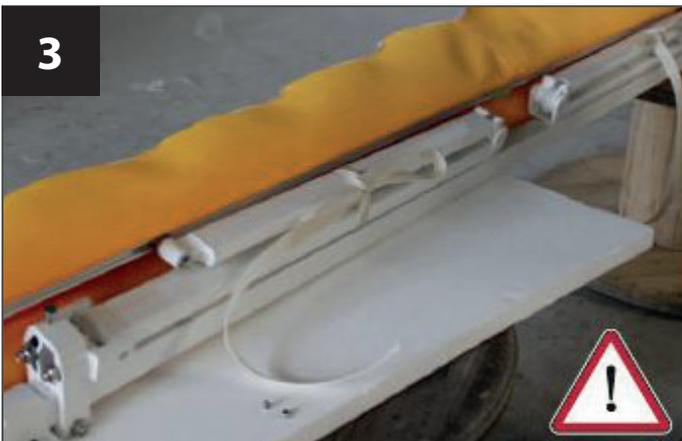
Sichern Sie die Gelenkarme mit einem Seil oder Spanngurt!
