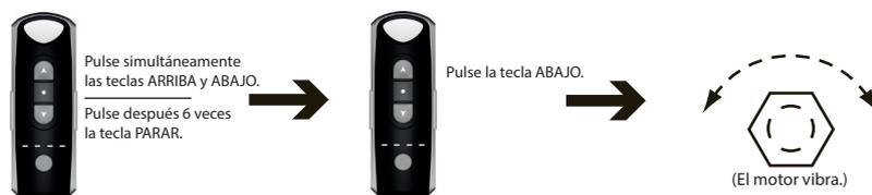
El motor girará ahora únicamente mientras se mantenga pulsada la tecla ARRIBA o ABAJO. En el modo manual, mantenga pulsada la tecla ARRIBA o ABAJO durante 3 s: el motor girará hasta el punto final o hasta que pulse la tecla PARAR.
