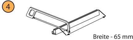
Ziehen Sie nun von dem im Schritt 1 ermittelten Breitenmaß 65 mm ab und kürzen Sie die beiden Führungsschienen auf die entsprechende Länge.
