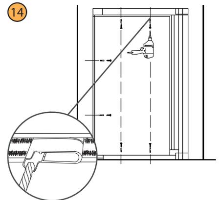
Für einen besseren Halt empfehlen wir das Verschrauben der Führungsschienen und der Magnetschiene mit dem Mauerwerk.
