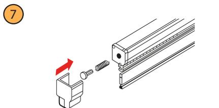
Führen Sie nun die Federn und Federbolzen in die seitlichen Öffnungen der Kastenendkappen (oben und unten). Platzieren Sie darüber die Endkappen mit Führungsschieneaufnahme.
