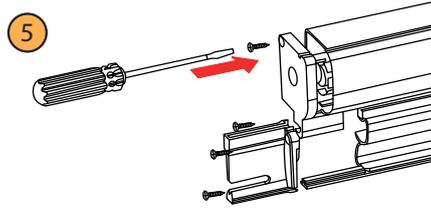
Stecken Sie den weißen Führungsadapter zurück in die Welle und schrauben Sie anschließend die Endkappe wieder an den Kasten.
