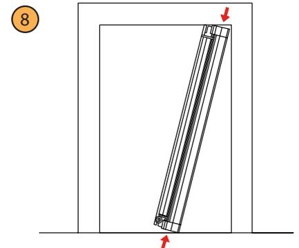
Führen Sie den fertigen Kasten seitlich in die Fensterlaibung ein. Achten Sie hierbei darauf, dass sich die Laufrolle auf der unteren Seite des Kastens befindet.
