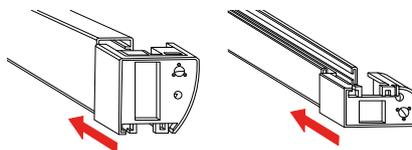
Befestigen Sie die Endkappen mit Führungsschieneaufnahme am Insektenschutzkasten sowie die Führungsschieneendkappen an den Enden der Führungsschienen.
