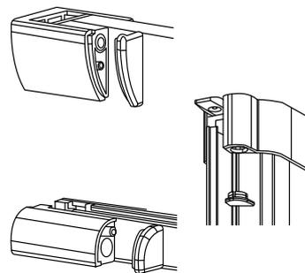
Decken Sie nun die Inbusschrauben der Kastenendkappen sowie der Führungsschienenendkappen mit den entsprechenden Schraubenabdeckungen ab.
