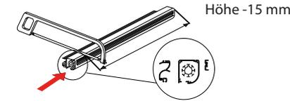
schiene auf die entsprechende Länge. Achten Sie hierbei darauf, dass die Endleiste bündig zur Schnittkante sein muss.
