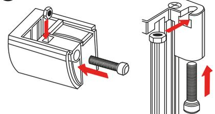
Befestigen Sie die Inbusschrauben und Muttern in den Führungsschienenendkappen sowie in den Endkappen des Insektenschutzkastens.
