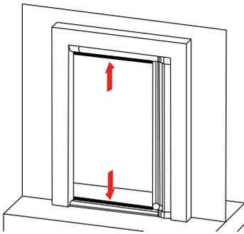
Setzen Sie nun die Führungsschienen von oben und unten in die Laibung ein. Achten Sie hierbei darauf, dass die Nuten der Führungsschienen auf die Nasen der Kastenendkappen geschoben werden.
