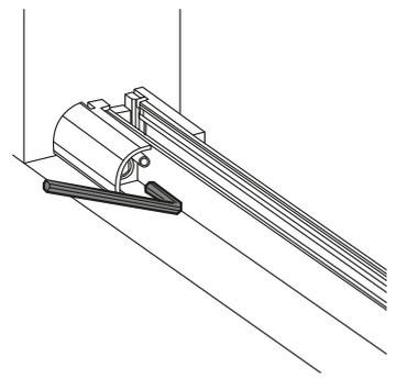
Verfahren Sie ebenso mit den Inbusschrauben in den Führungsschienenendkappen.
