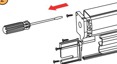
Entfernen Sie die linke Endkappe des Insektenschutzkastens und ziehen Sie diese aus der Kassette. **Achten Sie dabei** auf den weißen Führungsadapter, welcher in der Welle steckt. Dieser muss ebenso vor dem Zuschneiden entfernt werden.
