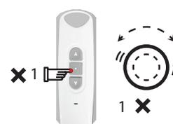
3. Pulse la tecla PARAR para salir del modo de programación. El sensor de movimiento se ha activado correctamente.
