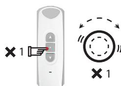
3. Pulse la tecla PARAR para salir del modo de programación. El motor vibrará una vez. El sensor de movimiento se ha desactivado correctamente.
