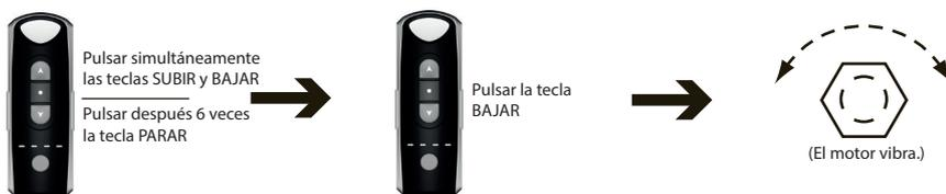
El motor girará ahora únicamente mientras se mantenga pulsada la tecla SUBIR o BAJAR. Si, en modo de funcionamiento manual, mantiene pulsada durante 3 s la tecla «Subir» o la tecla «Bajar», el motor girará hasta que se alcance la posición final o hasta que pulse la tecla «Parar».
